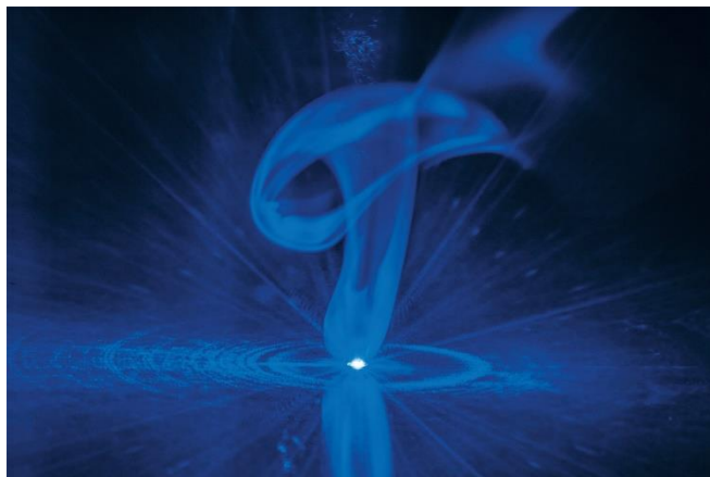
Bild 2: Im Prozell-Projekt HoLiB untersucht das Fraunhofer ILT u. a., mit welchen Laserstrahlquellen sich Anoden und Kathoden mit Kontakten besonders prozesssicher und schnell verbinden lassen (im Bild: Fügeprozess mit blauem Diodenlaser). © Fraunhofer ILT, Aachen.
