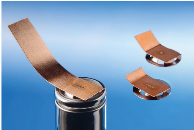
Bild 1: Im Rahmen des IGF-Projekts MikroPuls entwickelt das Fraunhofer ILT Laserverfahren für die effiziente Kontaktierung von Batteriezellen (im Bild: lasergeschweißte Kupferverbinder an zylindrischen Zellen). © Fraunhofer ILT, Aachen.
