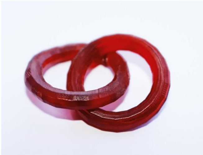
Bild 1: Mit dem neuen »TwoCure«-Verfahren aufgebaute Ring-in-Ring-Struktur, hergestellt ohne tragende Stützstrukturen und ohne direkten Kontakt zur Bauplattform. © Fraunhofer ILT & Rapid Shape GmbH.
