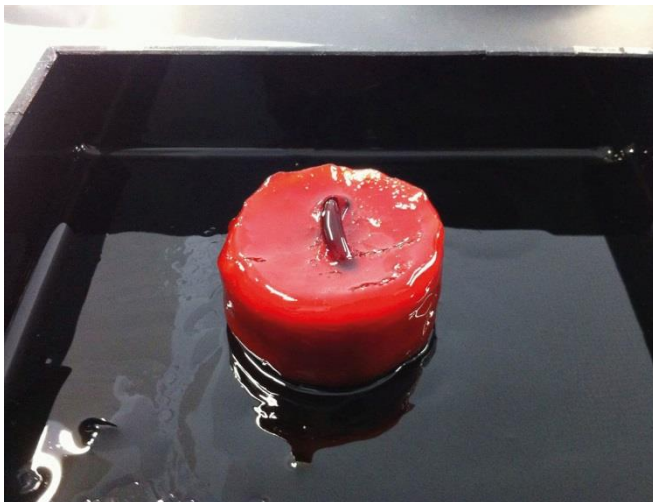
Bild 2: Verflüssigung eines zuvor aufgebauten Bauteils, bei der das stützende Material abfließt. © Fraunhofer ILT & Rapid Shape GmbH.
